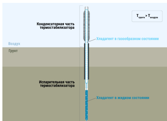
Рисунок 1 Конструкция и принцип работы термостабилизатора
