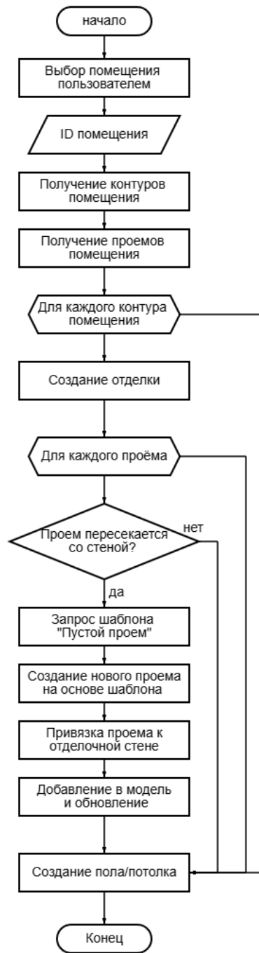
Рисунок 2. Блок-схема алгоритма учёта проёмов в NanoCAD BIM Строительство
