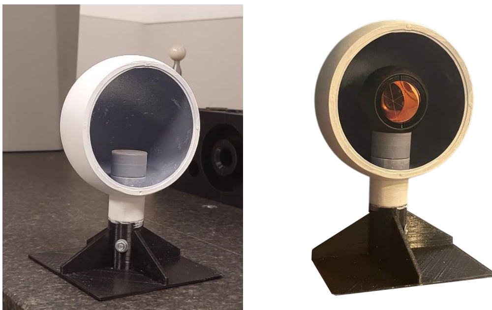
Рис. 4. Составные сферические марки
