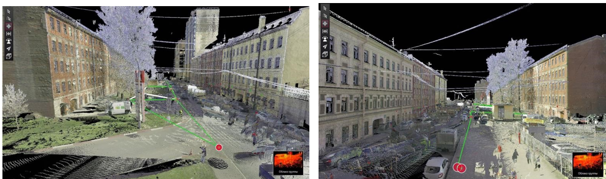
Рис. 1. Облако точек нулевого цикла работ с ПО Leica Cyclon Register 360
