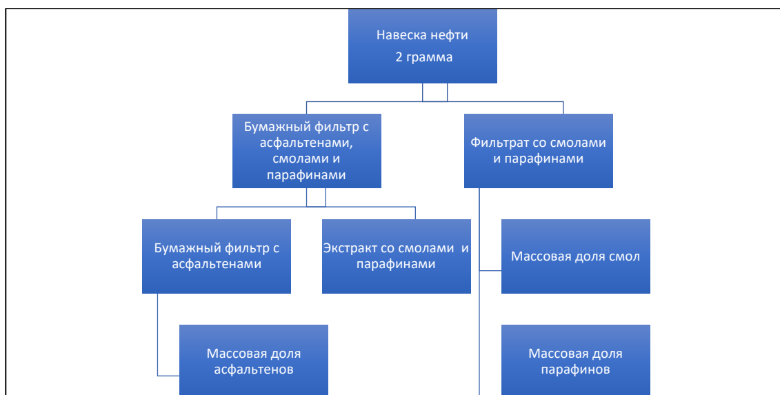
Рисунок 4. Общая схема проведения анализа классическим методом
