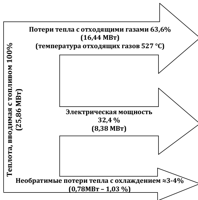
Рисунок 8 – Балансовая схема энергетических потоков теплового двигателя
