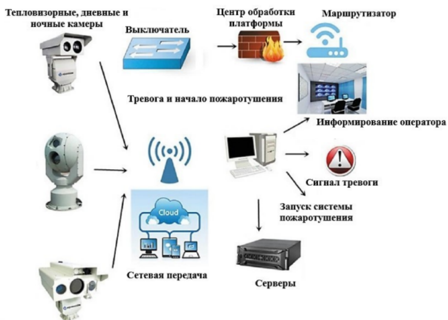
Рисунок №2. Схема интеллектуальной технологии видеонаблюдения Заключение
