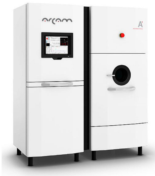
Рисунок 13. Промышленная EBM установка производства шведской компании Arcam AB
