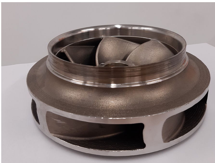
Рисунок 15. Пример крыльчатки изготовленной методикой SLM
