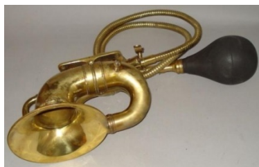
Рисунок 8. Комбинированный клаксон: пневматическая система дублируется механической
