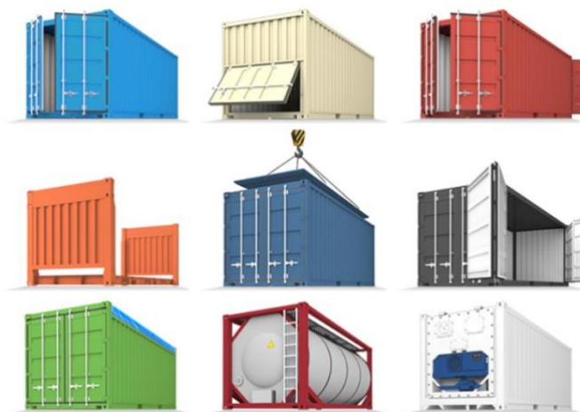
Рисунок 14. Многообразие контейнеров в зависимости от решаемых задач, вида и класса перевозимого груза
