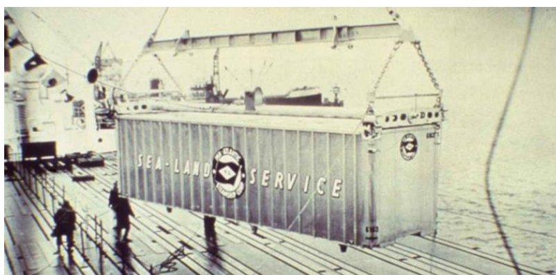
Рисунок 8. Процесс перевалки контейнера с автомобильной платформы на судно-контейнеровоз
