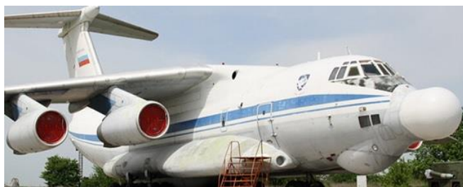
Рисунок 2. Самолет Ил-76 в модификации воздушной лаборатории А-60
