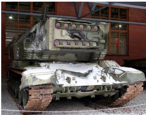
Рисунок 5. Самоходный лазерный комплекс 1К17 «Сжатие»
