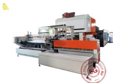
Рисунок 2 — Плоскощелевой экструдер для производства пятислойной стрейч-пленки
