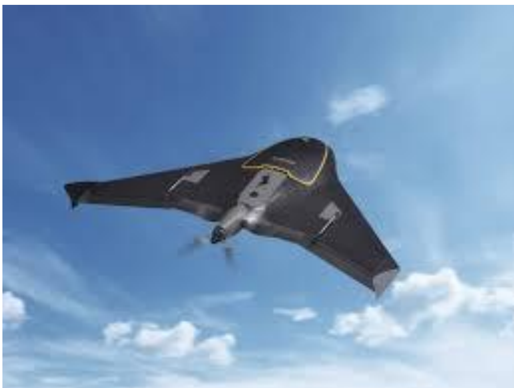
Рисунок 6 - Самолетный БПЛА Trimble UX5
