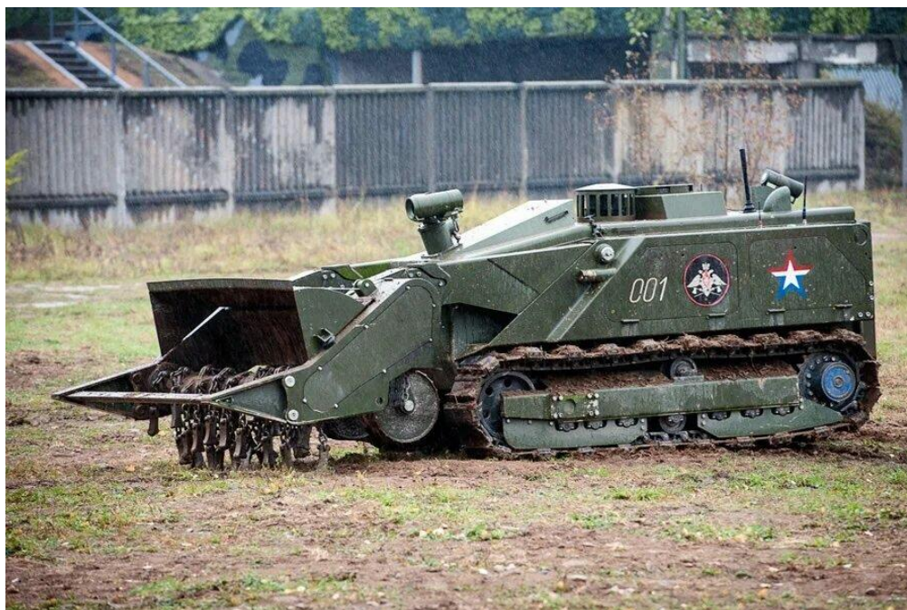
Рис.1 «Уран-6» — многофункциональный робототехнический комплекс разминирования.
