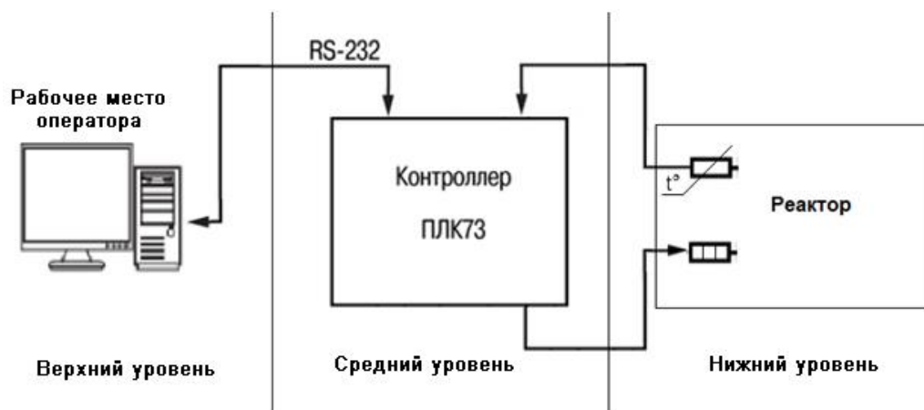
Рис. 2 - Схема взаимодействия между уровнями АСУТП
