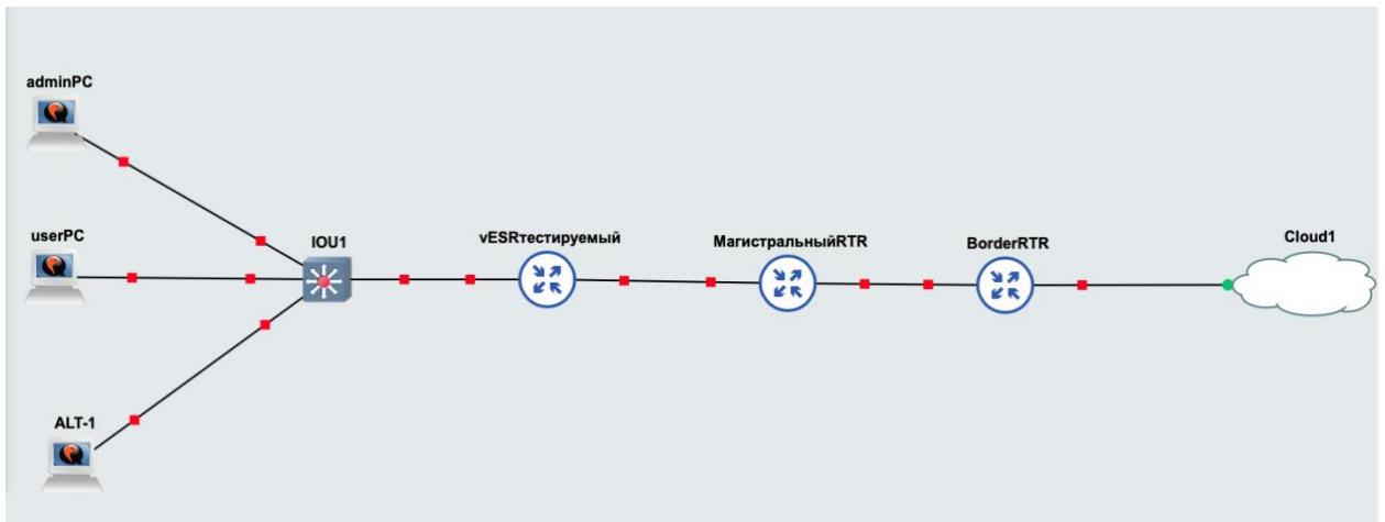
Рисунок 1 – Топология тестового стенда в GNS3
