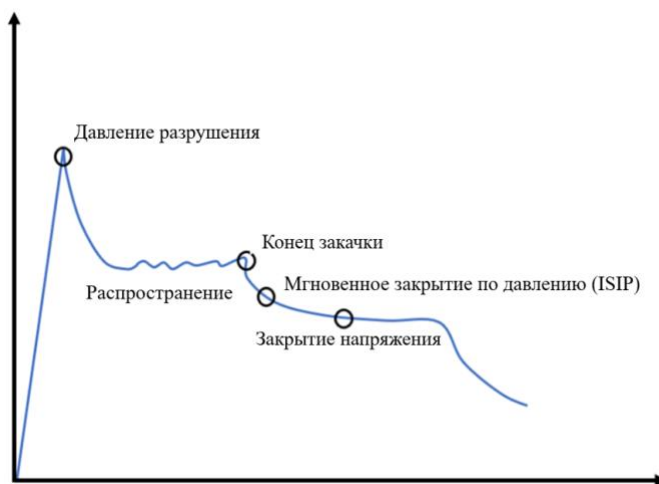
Рисунок 5 – Различные стадии и поведение породы при увеличении давления закачки
