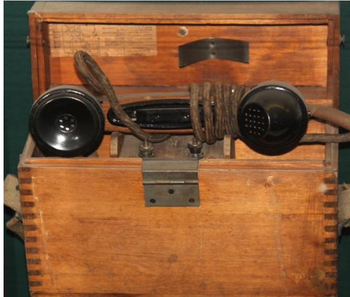
Рис.1. ПФ- – аппарат телефонный полевой
