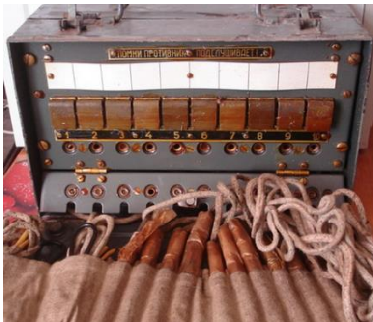
Рис. 2. К-10 – Коммутатор телефонный полевой
