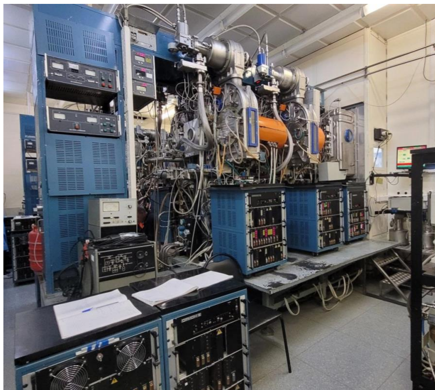
Рисунок 1 – Оборудование «Электроника ТМ-1203 (Оратория-36)» [1]
