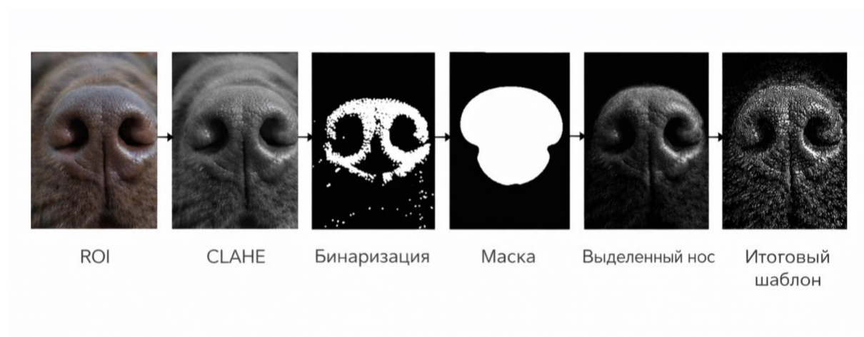
Рис. 2. Пример последовательности предобработки ROI: усиление контраста, бинаризация, маска и итоговый текстурный шаблон.
