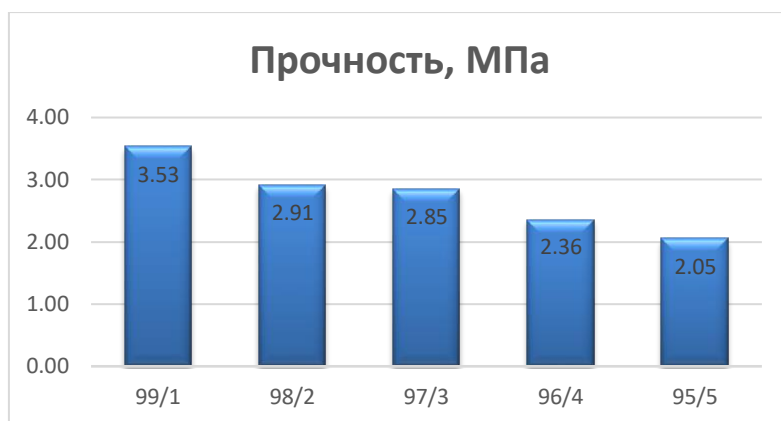
Рисунок 4 – Изменение прочности на сжатие в зависимости от концентрации микросфер
