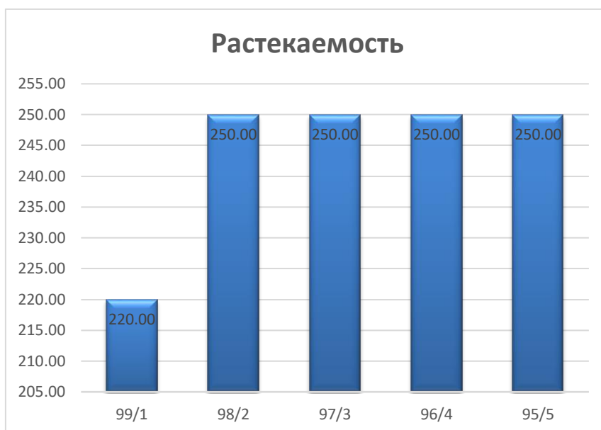
Рисунок 5 – Изменение растекаемости в зависимости от концентрации микросфер
