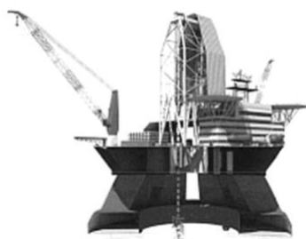
Рисунок 6. Катамаранная ППБУ JBF Arctic [26]
