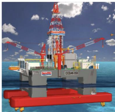
Рисунок 8. Катамаранная ППБУ OCEAN 850 [7]
