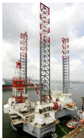
Рисунок 8. Самоподъемная буровая установка «Мурманская» [7]
