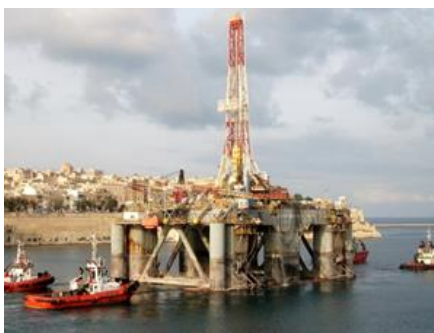
Рисунок 7. Полупогружная буровая установка Sedco 710 (система DP-3) [7]
