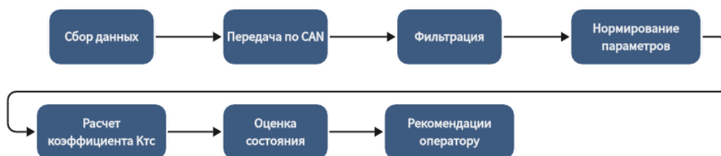
Рисунок 2 – Алгоритм обработки телеметрических данных
