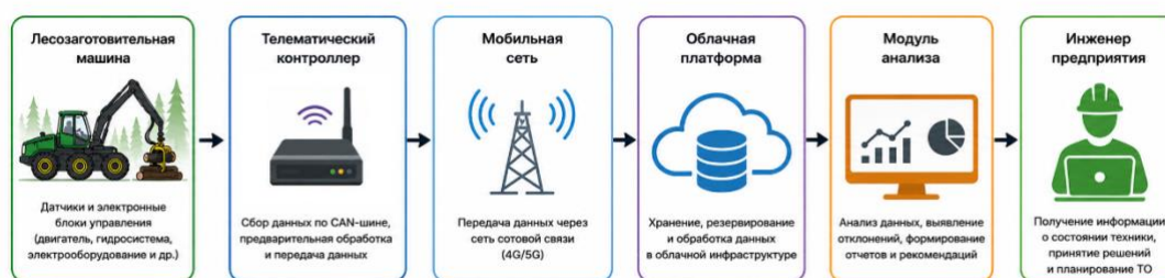
Рисунок 3 – Поток обработки данных в цифровой системе
