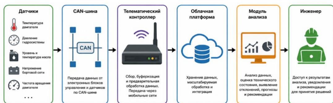
Рисунок 1 – Архитектура цифровой системы мониторинга
