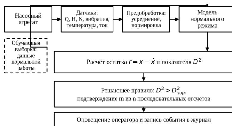
Рис. 1. Структура системы автоматического обнаружения аномалий
