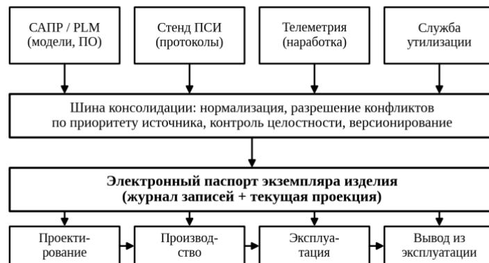
Рис. 2. Схема консолидации данных стадий жизненного цикла в электронном паспорте
