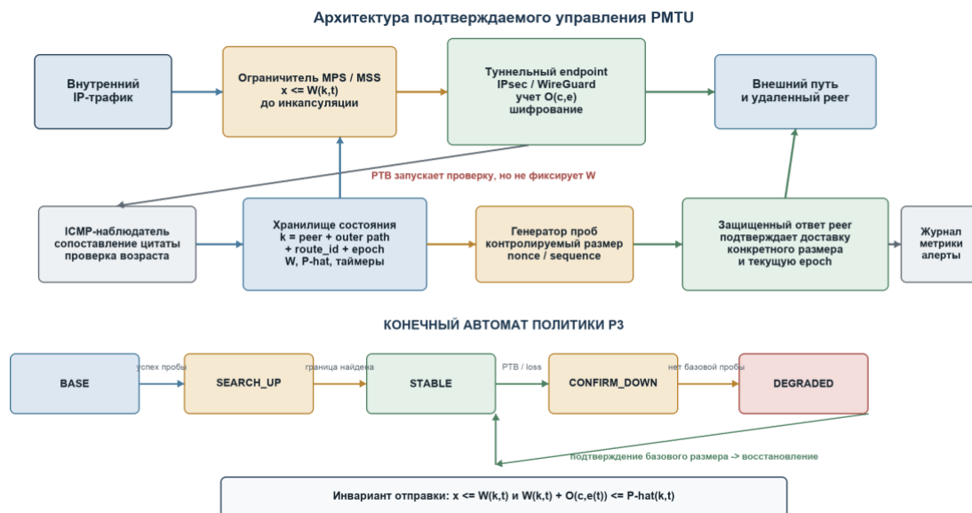
Рисунок 2. Архитектура подтверждаемого управления PMTU и автомат P3
