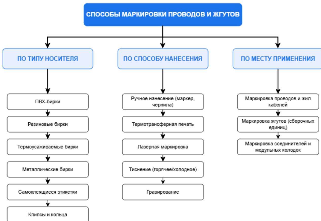
Рис. 1 – Классификация способов маркировки проводов и жгутов.
